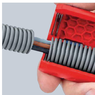
Чистый край среза и неповреждённый провод, идущий внутри, поскольку режется только внешняя гофра
