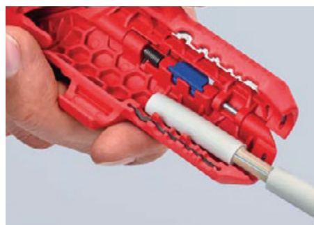
Удаление изоляции с провода NYM
