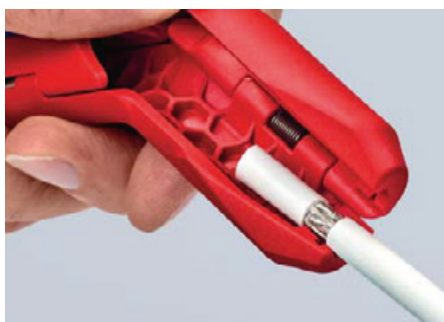
Удаление изоляции с коаксиального кабеля
