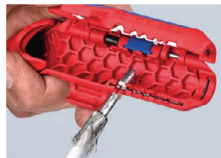
Удаление изоляции с коаксиального кабеля
