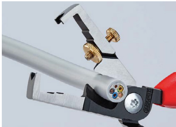
Закалённые токами высокой частоты лезвия резака с прецизионной заточкой режущих кромок для резания без деформации медного провода диаметром до 15 мм (5 × 2,5 мм 2 )
