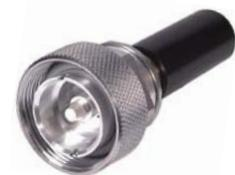
\* Величина максимальной непрерывной мощности составляет 50 Вт при установке согласованной нагрузки на дополнительный радиатор с максимальной величиной теплового сопротивления ( $R_{th}$ ) 5 К/Вт. При использовании согласованной нагрузки без дополнительного радиатора величина максимальной непрерывной мощности составляет 25 Вт.
