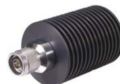
\* Величина максимальной непрерывной мощности составляет 50 Вт при установке согласованной нагрузки на дополнительный радиатор с максимальной величиной теплового сопротивления ( $R_{th}$ ) 5 К/Вт. При использовании согласованной нагрузки без дополнительного радиатора величина максимальной непрерывной мощности составляет 25 Вт..
